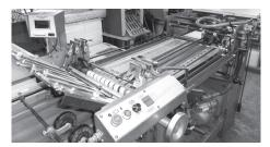
Sonnenberg (on peut voir deux rouleaux de fil de fer; la machine peut brocher et fois!). Ou bien le livre peut être relié par une colle spéciale grâce à la machine C.P. Bourg 'Perfect Binding' opérée par Mlle
